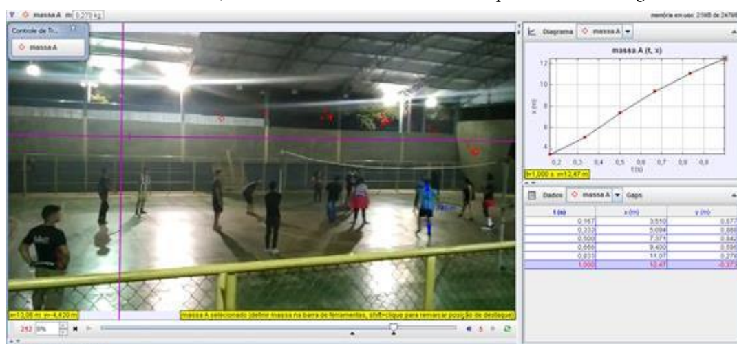
Figura 2 – Tela do software Tracker, com o movimento analisado e os respectivos dados em gráfico e em tabela.
